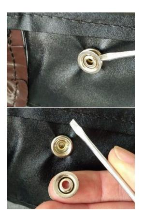
Fig. 13-1: Separate press studs if necessary
