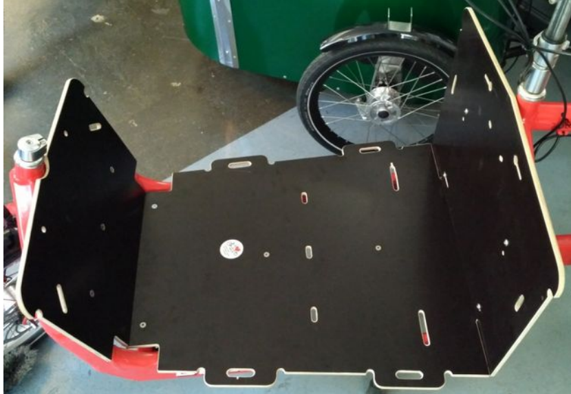
Abb. 7: Platten ausrichten, Muttern mit Drehmoment anziehen
