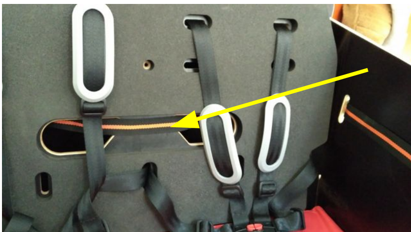
Abb. 10-2: Gurt einfädeln, Sitzlehne einschließen
