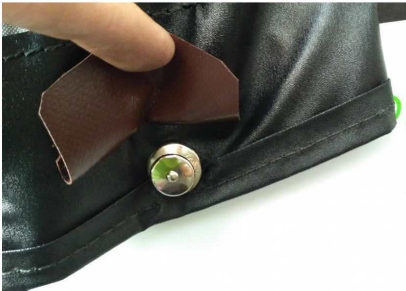
Fig. 13-8 : Tenax clipsé (ancien modèle)
