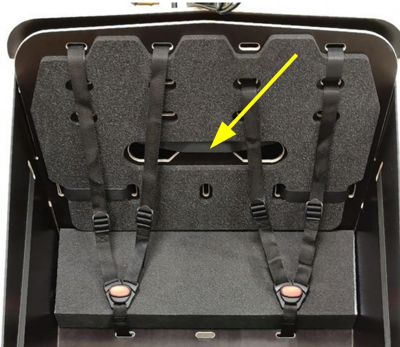
Fig. 11-2 : IMPORTANT pour la sécurité ! Enfiler la ceinture, Inclure le dossier du siège
