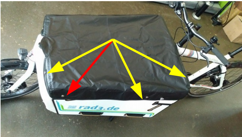
Fig. 13-3 : Tendre la bâche, les boutons-pression à droite sont inversés
