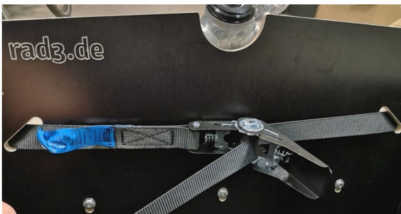
Fig. 11-3 : serrer avec une clé à cliquet
