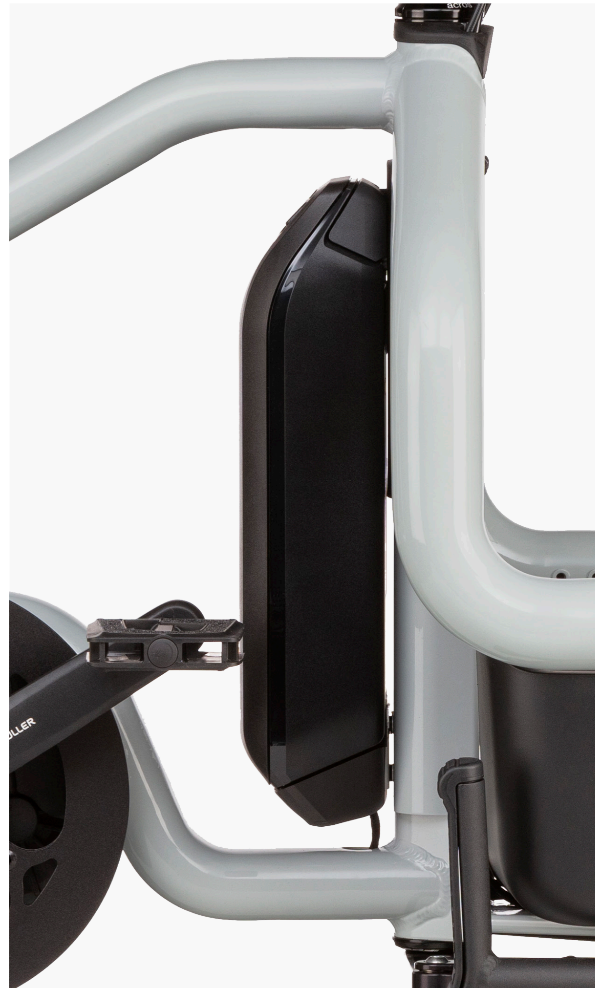
Der PowerPack 545 Wh Akku ist senkrecht am Rahmen angebracht. Ein Upgrade auf den 725 Wh Akku ist möglich.
